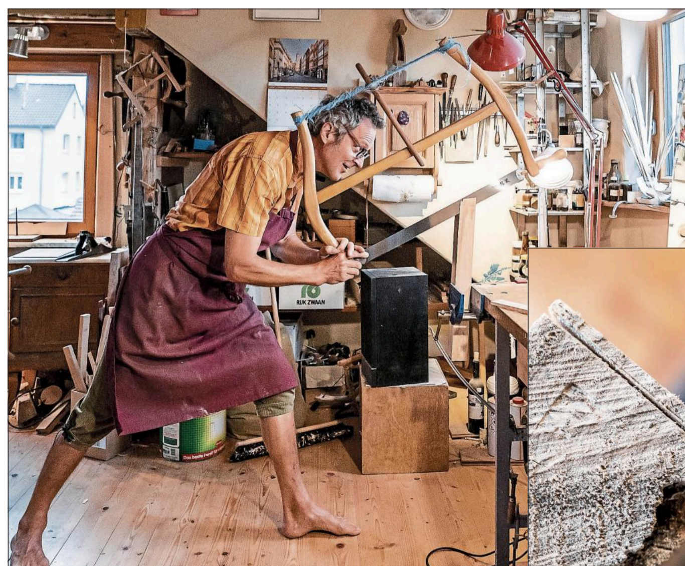
Ein feiner Schnitt mit großer Säge: Die Zargen werden von Hand ausgesägt.
