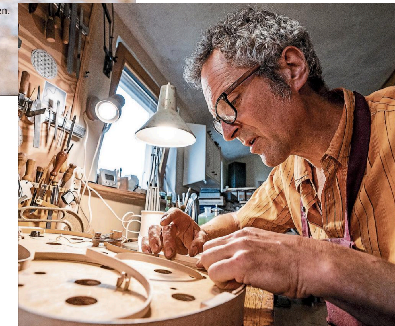
Dietmar Schweizer passt die Zarge an die Innenform an.
