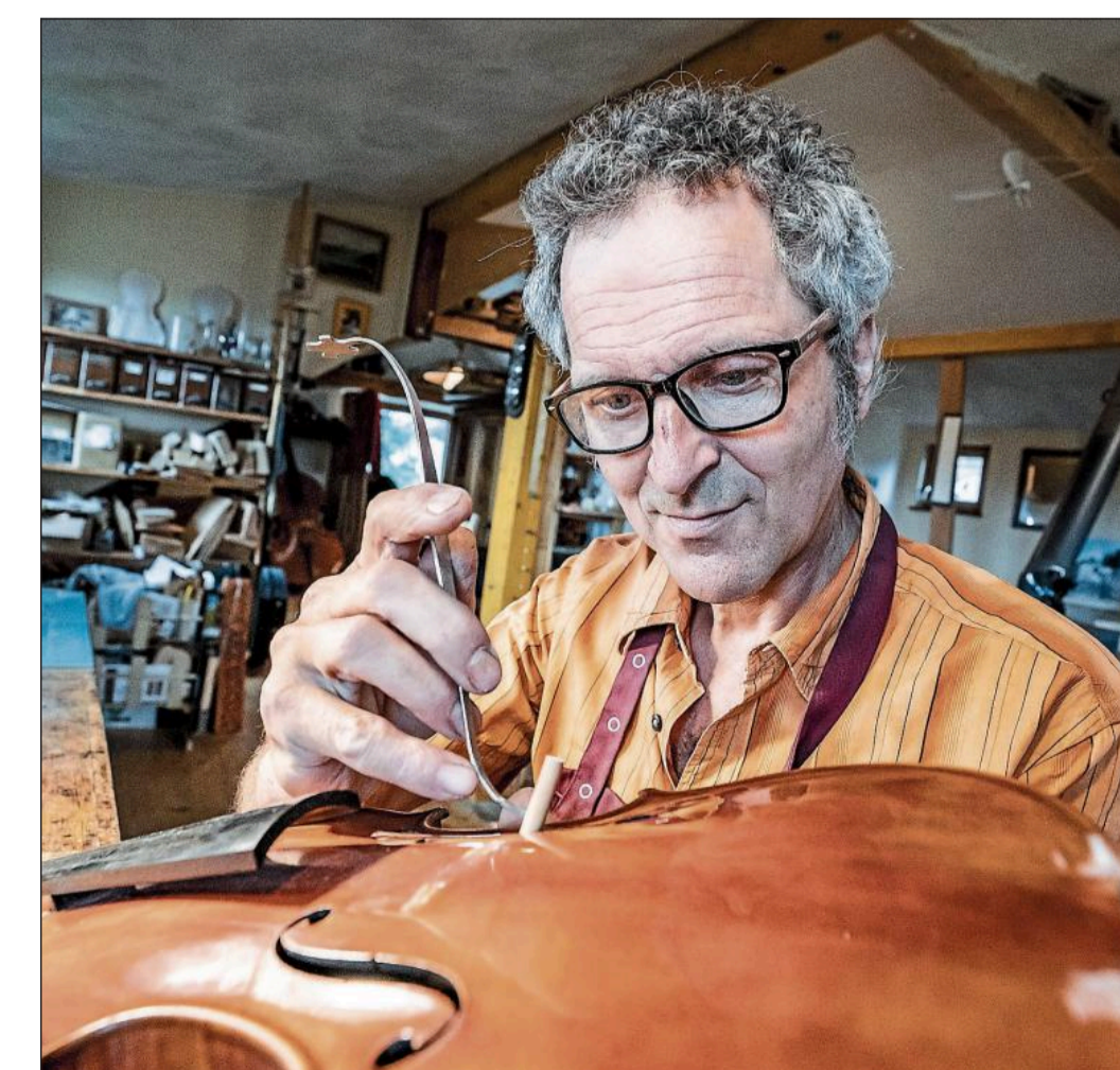
Das Einsetzen des Stimmstocks erfordert Geschick.
